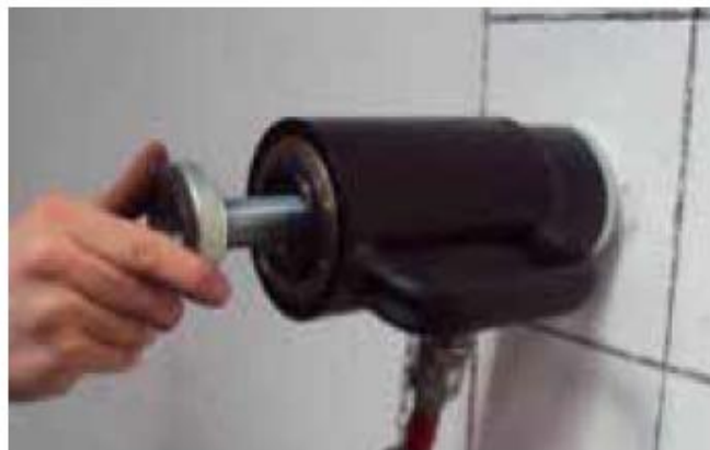
Fase 8: posizionamento e fissaggio del martinetto e collegamento del tubo idraulico alla pompa
