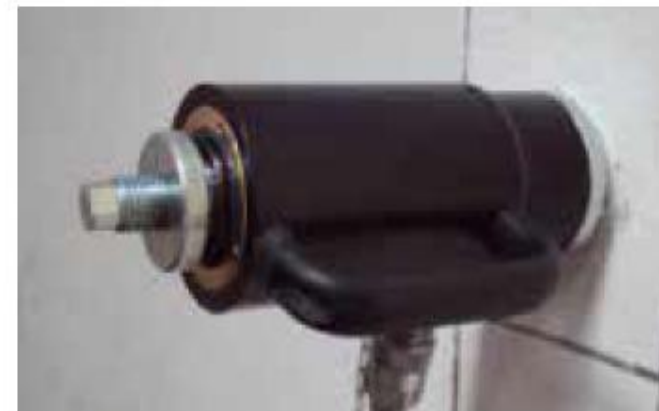
Fase 8: posizionamento e fissaggio del martinetto e collegamento del tubo idraulico alla pompa
