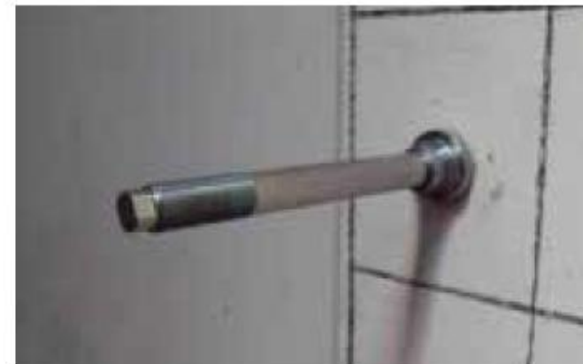
Fase 7: avvitamento dello stelo estrattore del martinetto oleodinamico alla filettatura del tassello
