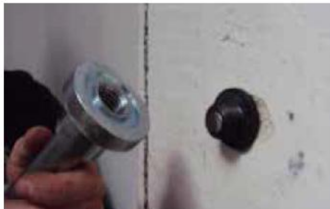
Fase 7: avvitamento dello stelo estrattore del martinetto oleodinamico alla filettatura del tassello
