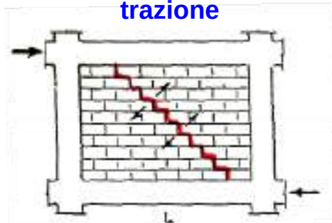
Rottura diagonale per trazione
